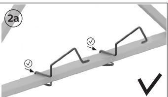
通过沿图1a和2a中2个箭头所示方向按压，将支架（B或C）钩在C形槽钢上。通过确保导向夹在槽钢下方，确保支架牢固地包围槽钢。以挂钩（B+C）为例，与所有其他类型的挂钩相同。
