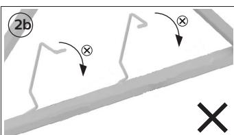
**重要：不要在挂钩的支臂上施加力（图1b和2b）。这可能会导致挂钩变形，对槽钢的固定不足，最终可能存在安全风险！**
