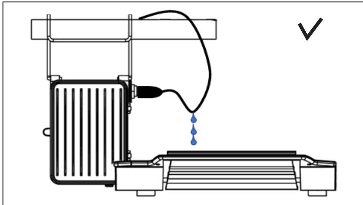
连接主电源电缆的母接头<CLICK>并将此主电源电缆连接到电网。通过引入一个回圈，确保释放电缆连接线的应力（请参阅第一页的安装图片）。
